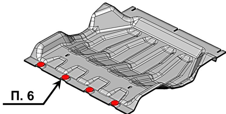
Схема установки закладной планки
