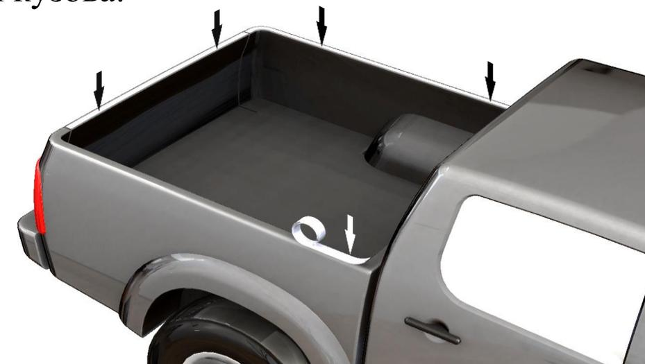
2. Установить крышку строго по центру кузова автомобиля. Обеспечить зазор мин.10 мм между кабиной и крышкой кузова.
