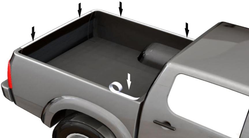
2. Установить крышку строго по центру кузова автомобиля. Обеспечить зазор мин.10 мм между кабиной и крышкой кузова.
